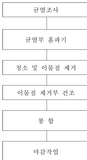
<그림 7.5.14> 교면포장 아스팔트 균열보수
